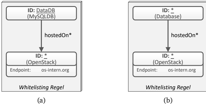
Abbildung 7.3: Vorgabe von Eigenschaften und Verwendung der Typisierung von Komponenten in Deployment-Regeln
