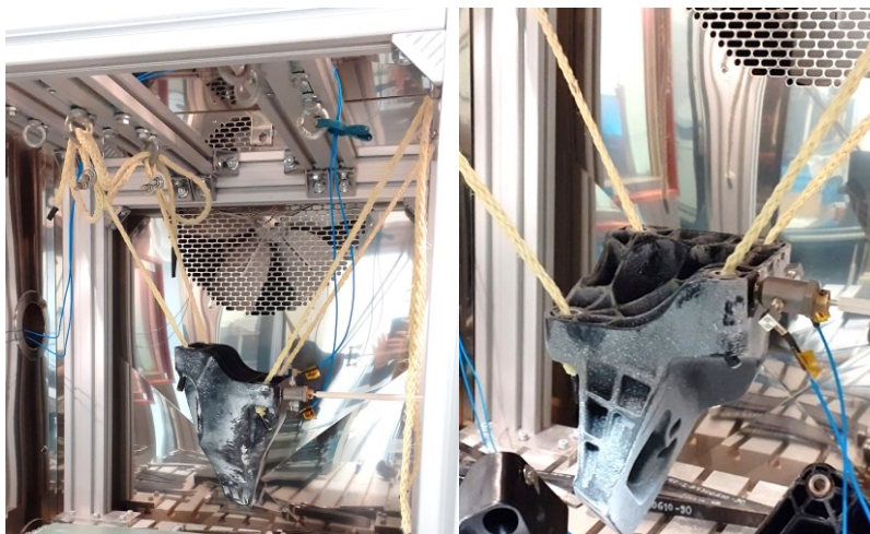
Abbildung 4.10: Messaufbau frei gelagerte Motorträger, links: 1K-MT, rechts: 2K-MT
