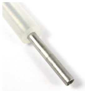
Abbildung 3.11: Gedämpfter Stinger, gefülltes Edelstahlrohr mit Silikonschlauch ummantelt [UAM21]
