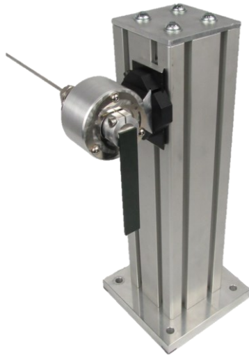
Abbildung 3.9: Höhenverstellbare Anbindung der Lagerungsstruktur
