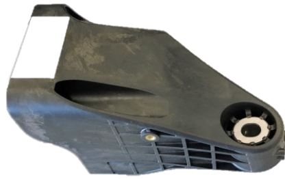
Abbildung 4.5: 1K-Motorträger aus dem Werkstoff A3WG10
