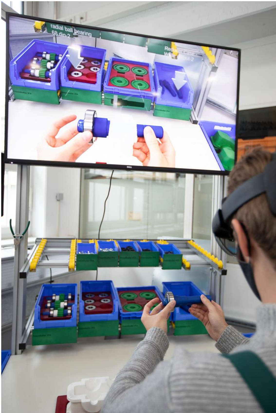
Abbildung 9.7 Arbeitsplatz 2 in der Montage: Werker/-in bei der Montage mit der automatisch generierten AR-Montageassistentz (Bild: Fraunhofer IPA)
