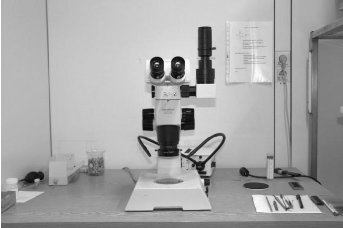
Abbildung 2-1: Stereomikroskop vom Typ SZX9 der Firma OLYMPUS mit Polarisationsfilter und externer Schwanenhals-Auflichteinheit.
