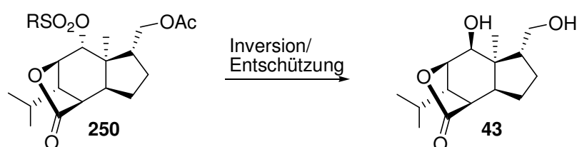
Abbildung 4.42: Inversion des sekundären Alkohols über die nucleophile Substitution eines Sulfonats
