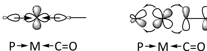
Abbildung 1.2: Orbitalwechselwirkungen zur Visualisierung von \sigma -Donor- (links) und \pi -Akzeptor-Beiträgen (rechts) zur Bindung zwischen Metallatom und Phosphan- bzw. Carbonylliganden in Übergangsmetallkomplexen. [2]
