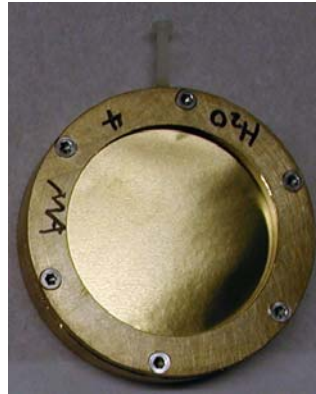
Abbildung 4.1: Für Myonenspinresonanz-Untersuchungen vorbereitete Probe. Aufsicht auf die mit Messingfolie verschlossene Flachseite des zylindrischen Probegefäßes.
