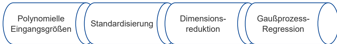
Abbildung 5.3: ML-Pipeline, die im Rahmen der erarbeiteten Vorgehensweise zum Einsatz kommt.
