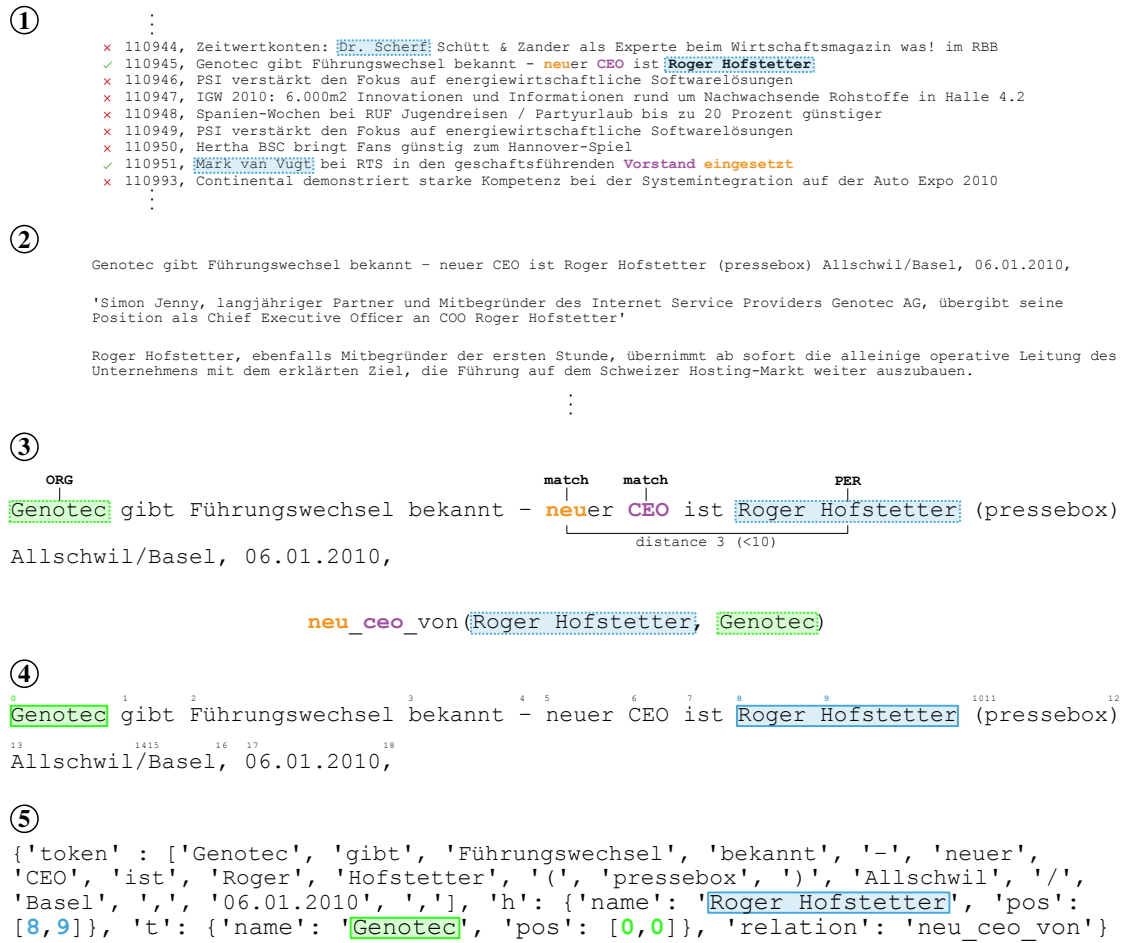
Abbildung 5.3.: Eine schematische Darstellung des Prozesses zur regelbasierten Generierung von Trainingsdaten.
