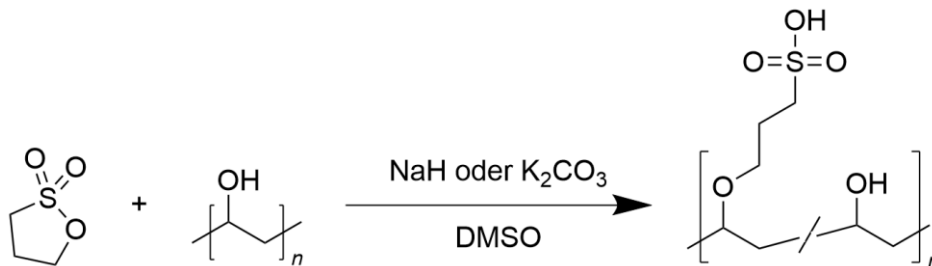
Abbildung 6: Reaktionsschema der Sulfonierung von PVA mit 1,3-Propansulton (1,3-Ps). Die Reaktion wird üblicherweise in Dimethylsulfoxid (DMSO) mit NaH oder K 2 CO 3 als Basen durchgeführt. 67, 68
