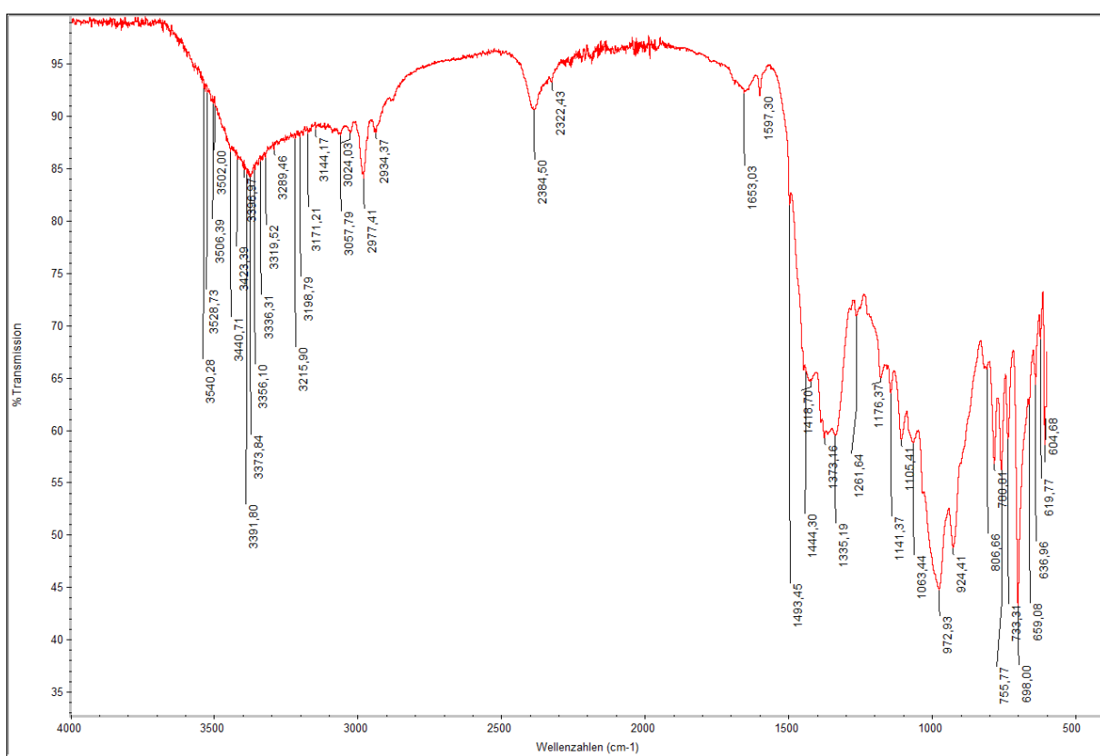
Abbildung A68: : FTIR-Spektrum des festen Rückstands der bei der Thermolyse von [7c]BH_3 entstanden ist.
