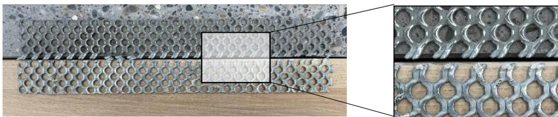
Abb. 8: Abgeschertes Streckmetall im Fugenbereich.
