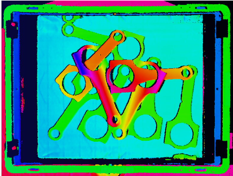
Abbildung 3.1: Punktwolke einer realen Kistensituation in der Roboterzelle in orthogonaler Projektion. Die z-Koordinate eines Punkts ist verantwortlich für die Farbgebung in der Darstellung.
