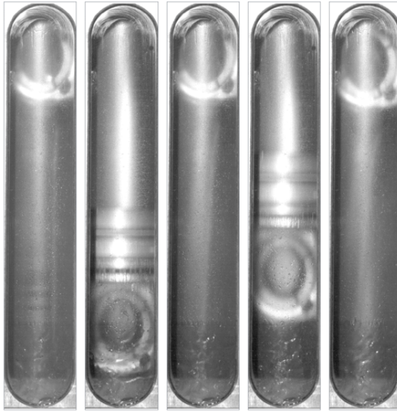
Abbildung 6.3: Drehbewegung innerhalb eines Arbeitsspiels, Optische Aufnahmen am Laser-Optischen Transparent Tribologie-Einzylindermotor, 4000\text{min}^{-1} Schubbetrieb
