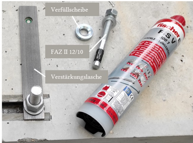
Abbildung 4.9: Verwendetes Material zum Verfüllen des Ringspalts für die Tastversuche der V-Profile.
