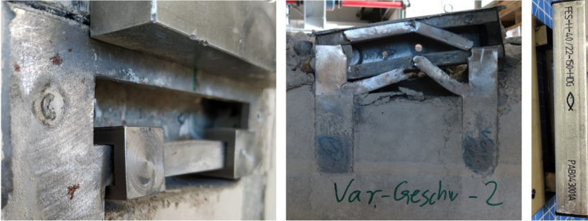
Abbildung 4.19: Untersuchte Anbindungsvarianten v.l.n.r. Klammern, Punktschweißen und Nutzenstein.
