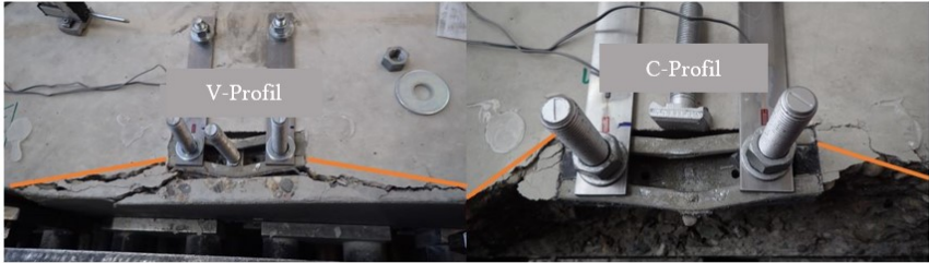
Abbildung 4.18: Versagensbild der nachträglich verstärkten V-Profile (links) und C-Profile (rechts).
