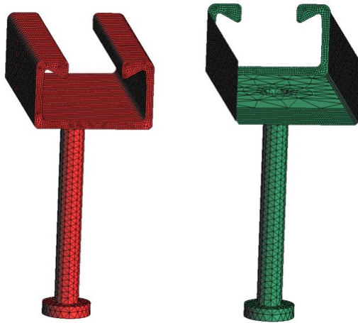
Abbildung 3.6: Darstellung der vernetzten Ankerschiene (links) und den umgebenden Interfaceflächen (rechts).
