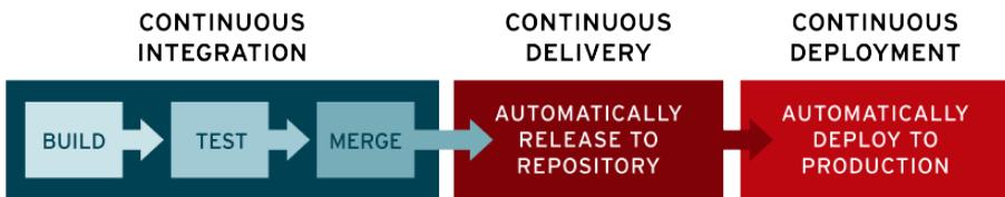
Abbildung 2.6: *CI und CD im Entwicklungsprozess. Einordnung von Continuous Integration, Continuous Delivery und Continuous Deployment im Entwicklungsprozess. (Quelle: Redhat)*
