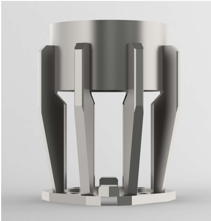
SSFE-Stütze bestehend aus unterer Gitterplatte, Rippen und Führungsrohr
