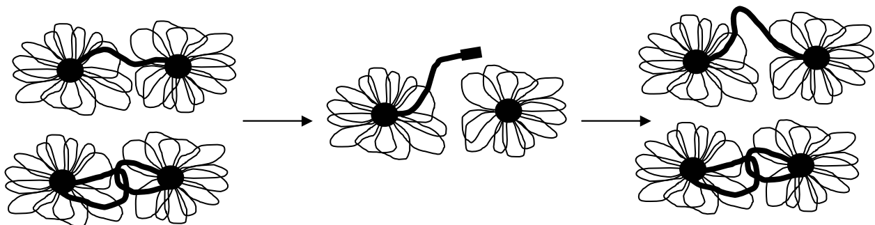
Abb. 4-34: Das Ablösen einer hydrophoben Endgruppe aus dem Mizellkern führt zur Trennung zweier Mizellen, mit der Möglichkeit anschließender neuerlicher Verknüpfung;
