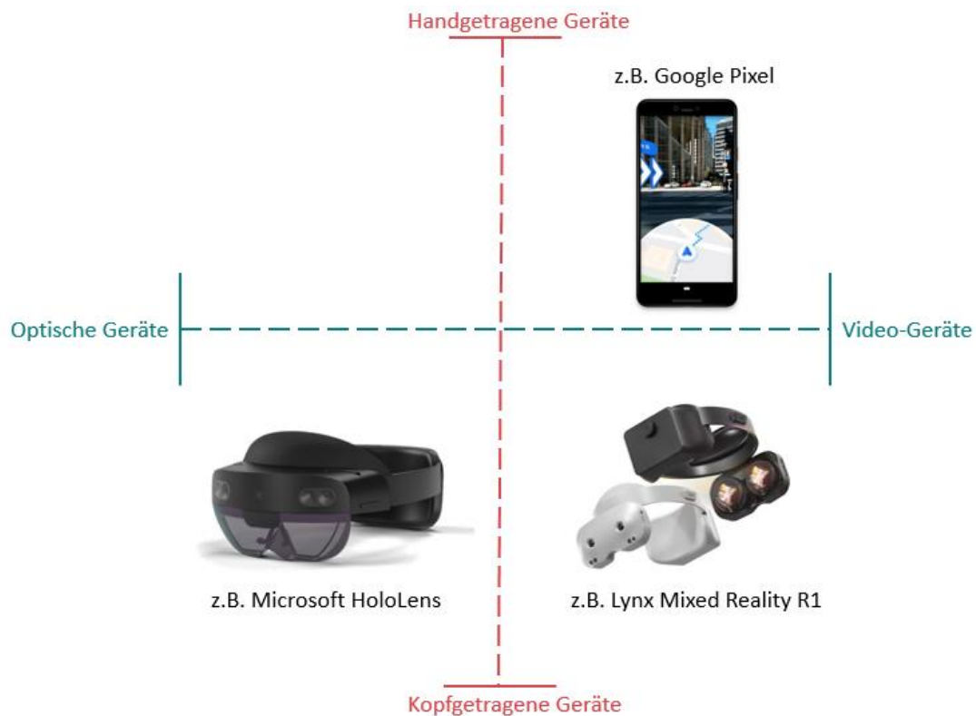
Abbildung 5: Übersicht der technischen Einteilung von AR-Ausgabegeräten nach (Dörner et al., 2019) mit Beispielen aus (Google, 2022b; Lynx Mixed Reality, 2023; Meisel, 2016)
