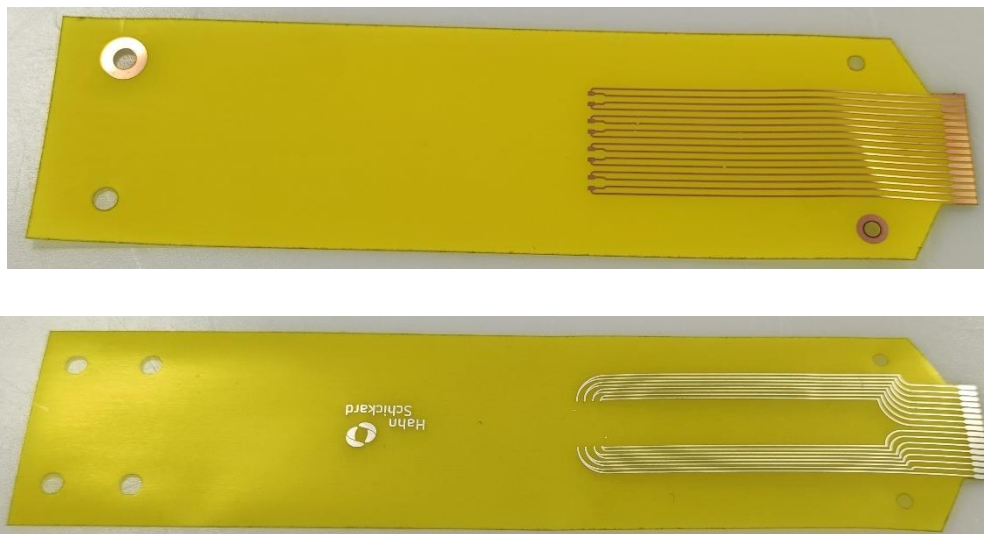
Abbildung 6-12: Erstellte Schaltung für die Biegeprüfung für 0603 (für 0402 sind nur die Pads kleiner). Oben ist die Metallisierung Standard-Kupfer, unten ImAg.
