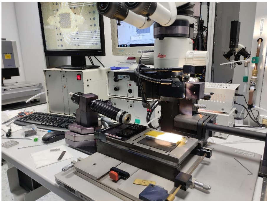
Abbildung 7-11: Auf dem Fineplacer befindet sich ein Foliensubstrat, das durch Vakuum fixiert ist. Auf dem Monitor auf der linken Seite ist ein Chip zu sehen, der auf den zuvor aufgetragenen Klebstoff ausgerichtet ist.
