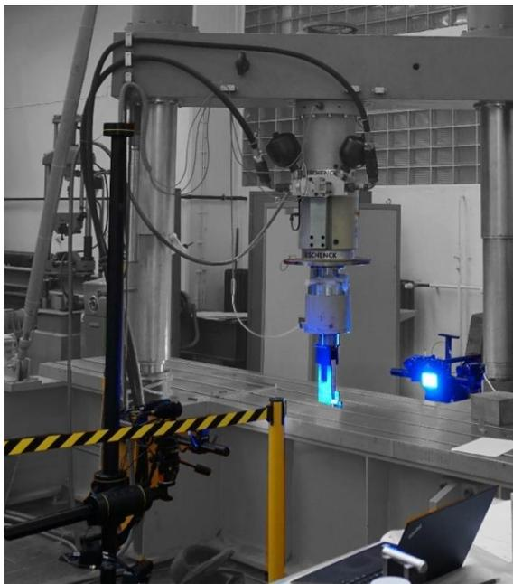
(a) Übersicht Prüfmaschine und optische Messsysteme ARAMIS
