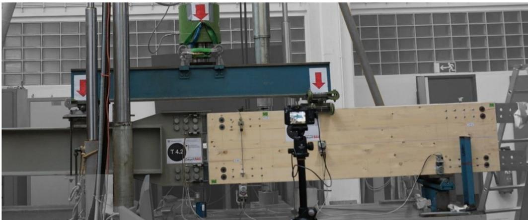
*Abb. 6.1: Versuchsaufbau Bauteilversuche Stützenfußpunkt als 4-Punkt-Biegeversuch*
