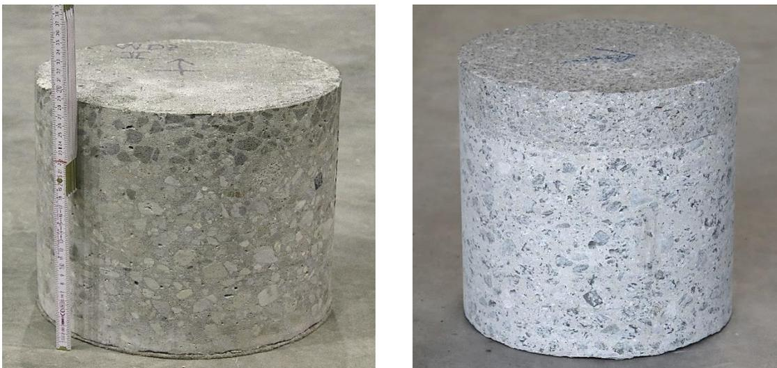
Abbildung 3.4: Bohrkern- mit einem Durchmesser von 300 mm aus zweischichtigen Decken mit Mörteltexturierung (links) und Waschbetontextur (rechts)
