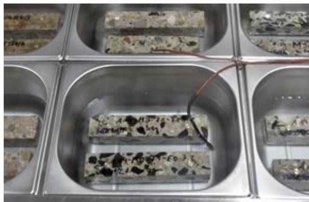
Abbildung 3.18: Prüfanordnung der Probekörper in einer CDF-Prüfanlage gemäß Prüfansatz 1
