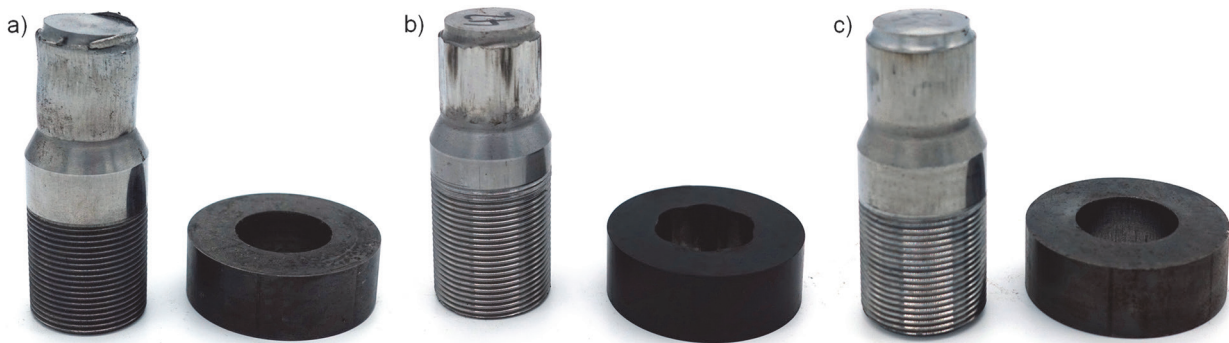
Bild 6.21: Getrennte Proben nach dem Abziehversuch: a) konturierte Fügefläche B-450; b) 3D-Fügefläche B-4; c) zylindrische Fügefläche A-Zyl.
