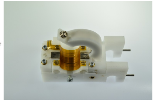
Abbildung 82: LVDT-Sensormuster als Flexleiter (links) und Einbau in Magnethalter der linear bewegten Pumpe (rechts)
