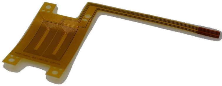
Abbildung 82: LVDT-Sensormuster als Flexleiter (links) und Einbau in Magnethalter der linear bewegten Pumpe (rechts)
