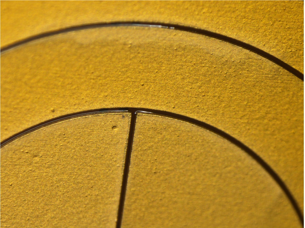
Abbildung 67: Isolationsgräben mit Inkjet-Drucker Dimatex DMP-2850 gefüllt
