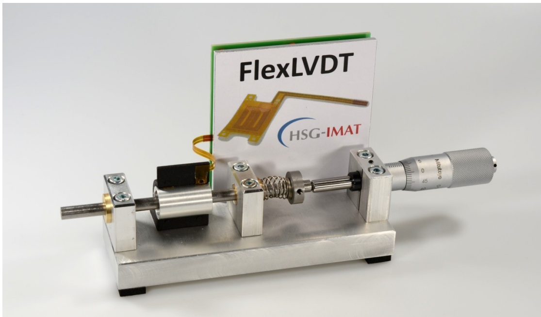
Abbildung 87: Prüfaufbau für den induktiven Positionssensor inkl. Ansteuerelektronik
