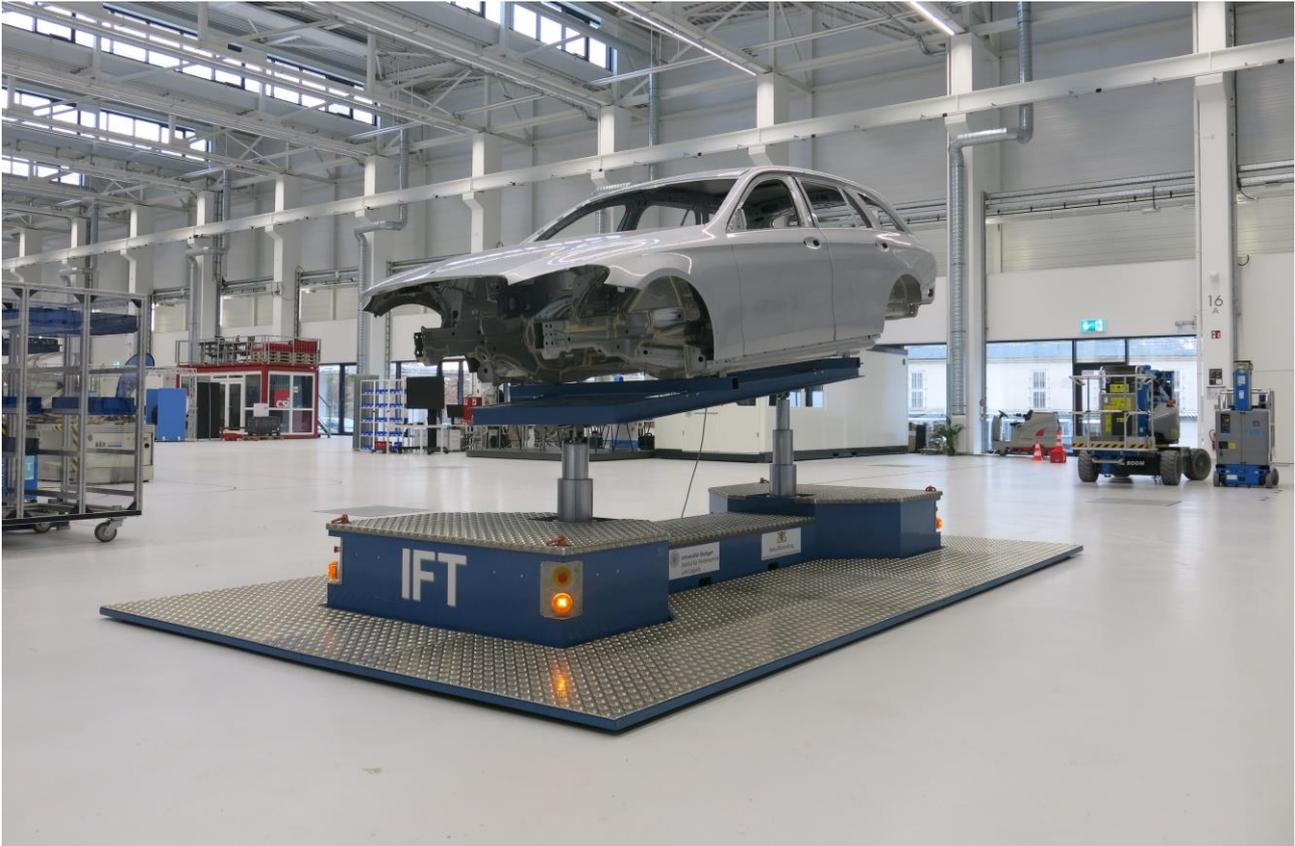
**Abbildung 6-10: Prototyp der mobilen Montageinsel in der Arena2036**
