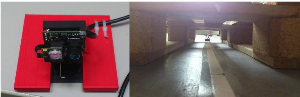
**Abbildung 5-46: Versuchsaufbau zur Durchfahrt einer Palette [GRO13]**
