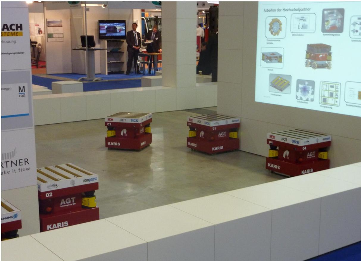
**Abbildung 2-6: KARIS-Fahrzeuge eingesetzt für Einzeltransporte [INT18]**
