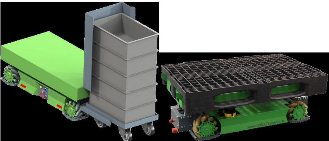
Abbildung 7-23: Lastmodul für KLT-Trolleys (links) und Paletten (rechts) [DON21]
