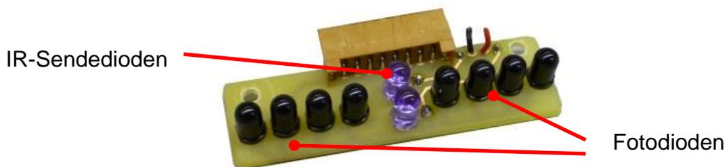
**Abbildung 5-22: Optischer Spurführungssensor**
