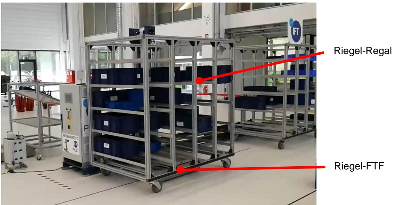
**Abbildung 6-7: Riegel-FTF dockt das Regalmodul an das Mini-Regalbediengerät an**
