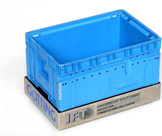
**Abbildung 5-1: erster Prototyp „Kleine automatische Transporteinheit“ (KaTe)**
