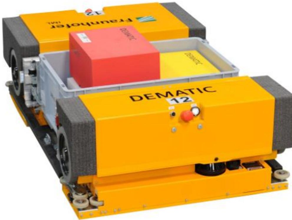
**Abbildung 2-2: Frei verfahrbare Variante, das Multishuttle Move [IML10-1]**
