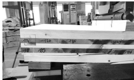
a) Referenz Fichte F-0: Rollschubversagen      b) Referenz Buche B-0: Längsschubversagen
