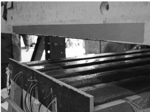
(c) Streifenförmige Verklebung
