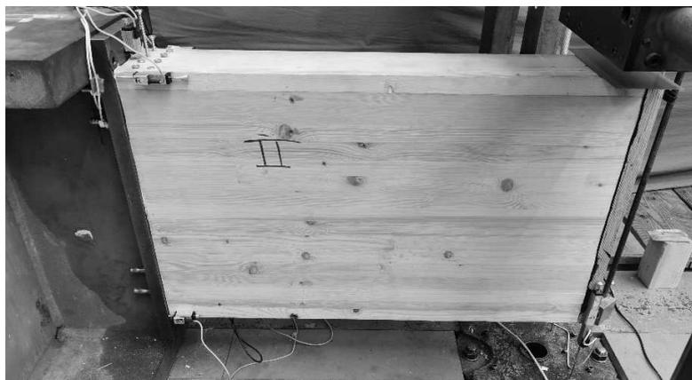
**Abb. 2:** Realisierter Versuchsaufbau der Serie III mit bauteilrelevanten Querschnittsabmessungen (für einen mittels Verstärkungsmethode A verstärkten Prüfkörper)
