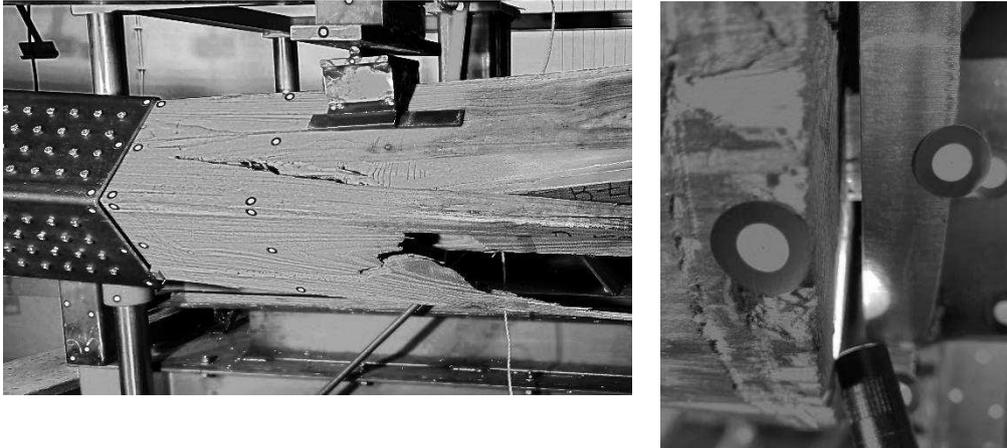
Abb. 9: Versagensstellen: Prüfreihe B-EQ (links) außerhalb der Hülse und B-EG (rechts) Herausziehen der Gewindestangen in der Zugzone
