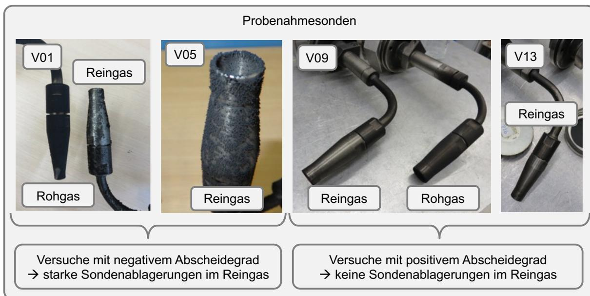
Abbildung 10.9: Ablagerungen an Staubprobenahmesonden bei der Untersuchung zum Einfluss der Betriebsweise am Kaminofen: Messungen hinter einem Elektroabscheider, Fotos veröffentlicht in Struschka et al (2016)
