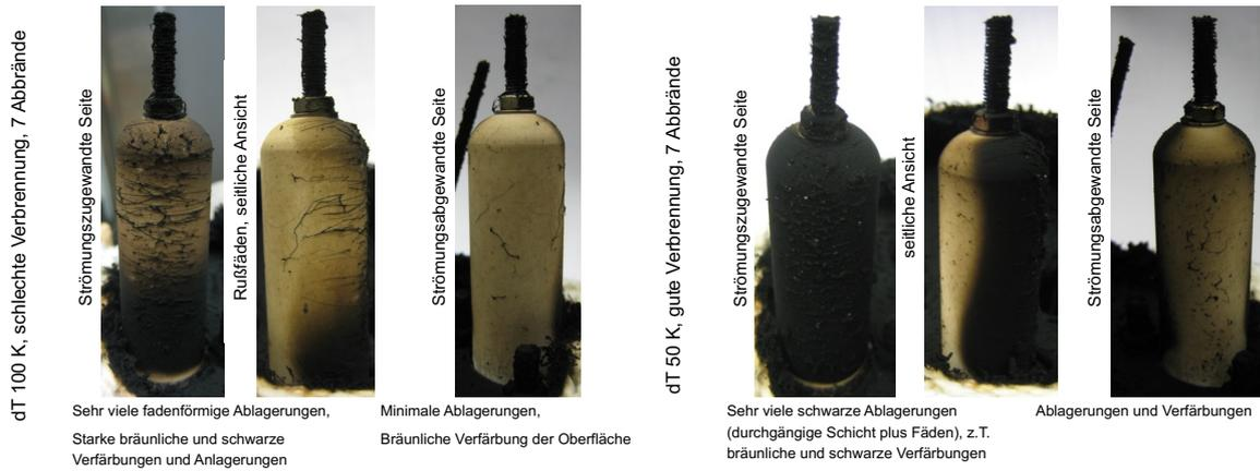
Abbildung 10.4: Einfluss der Strömungsrichtung auf Ablagerungen am Hochspannungsisolator bei Verbrennungsversuchen
