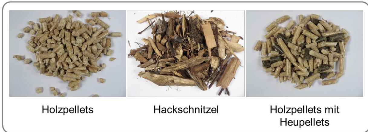
Abbildung 6.3: Verwendete Brennstoffe: links: handelsübliche Holzpellets, mitte: handelsübliche Holzhackschnitzel mit Rindenanteil, rechts: Pelletmischung Holzpellets mit Heupellets-Anteil
