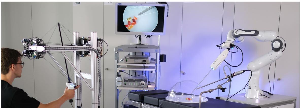
Abbildung 7.1: Handhabung von Objekten mit dem Telemanipulationssystem das im Rahmen dieser Arbeit entstanden ist.
