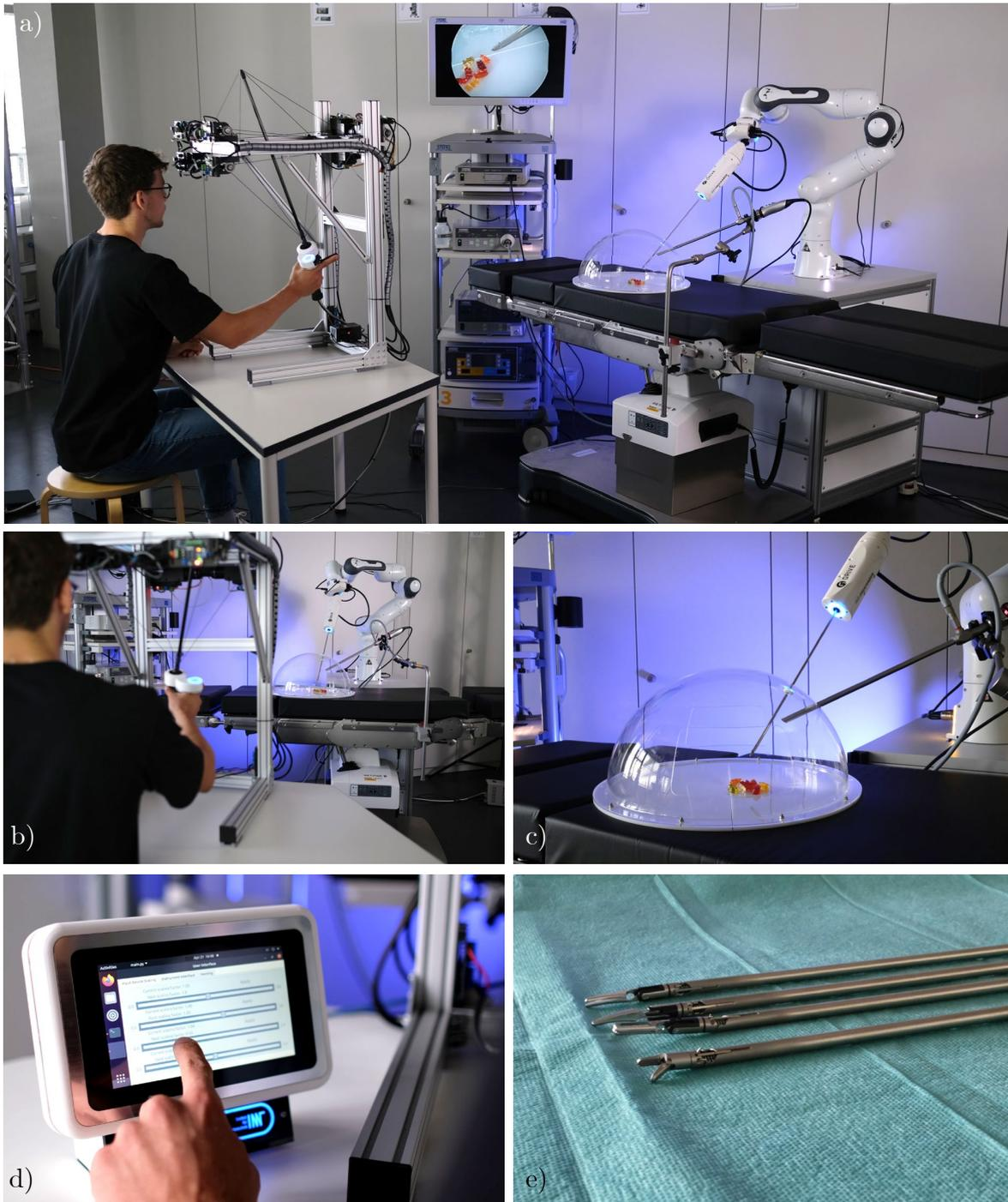
Abbildung 3.1: Telemanipulationssystem KISSROB im Experimental-OP des Instituts für Medizingerätetechnik der Universität Stuttgart (a) sowie Detailansichten von Teilsystemen und Komponenten (b–e).
