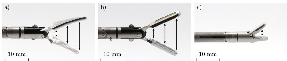
Abbildung 4.14: Endeffektortypen Dissektor (a) und atraumatischer Greifer (b) mit proximaler, medialer und distaler Messposition, und Nadelhalter mit medialer Messposition (c) (nach [113], CC BY 4.0).
