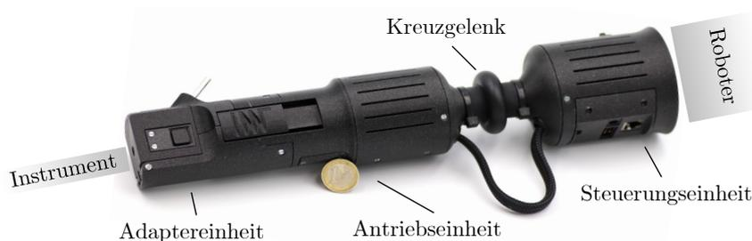
Abbildung 3.5: Instrumentenadapter für starre Instrumente (nach [109], mit Genehmigung von Springer Nature Switzerland AG).
