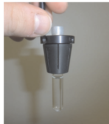
Abbildung 3.5: Links: Experimenteller Aufbau der Messapparatur für die dynamische Lichtstreuung. Rechts: Eine für die DLS-Messung vorbereitete Probe im Probenhalter.
