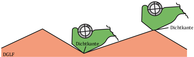
Bild 3.2: Modellvorstellung bei rollgedrehten DGLF
