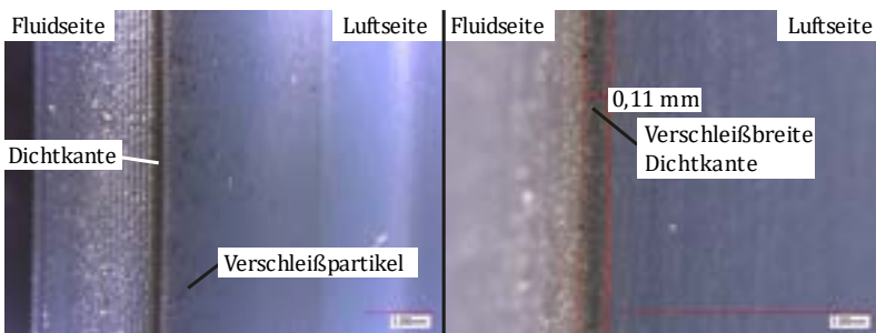
Bild 5.3: Ungereinigte (links) und in gereinigtem Zustand vermessene (rechts) Dichtkante
