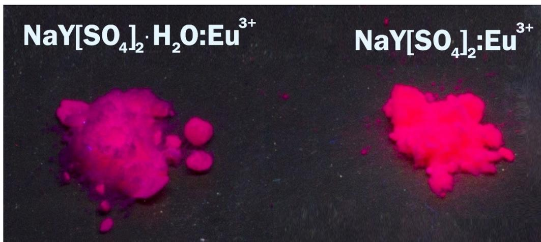
**Abbildung 10.11:**  $\text{NaY}[\text{SO}_4]_2 \cdot \text{H}_2\text{O}:\text{Eu}^{3+}$  (links) und  $\text{NaY}[\text{SO}_4]_2:\text{Eu}^{3+}$  (rechts) unter Bestrahlung von UV-Licht einer Wellenlänge von 254 nm. Die Proben haben einen Dotierungsgrad von 0,5 mol-%  $\text{Eu}^{3+}$ .
