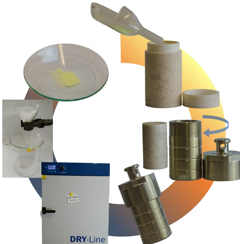
**Abbildung 2.2:** In dieser Arbeit verwendete Teflon-Autoklaven sowie vereinfachtes Schema der Experimente darin.
