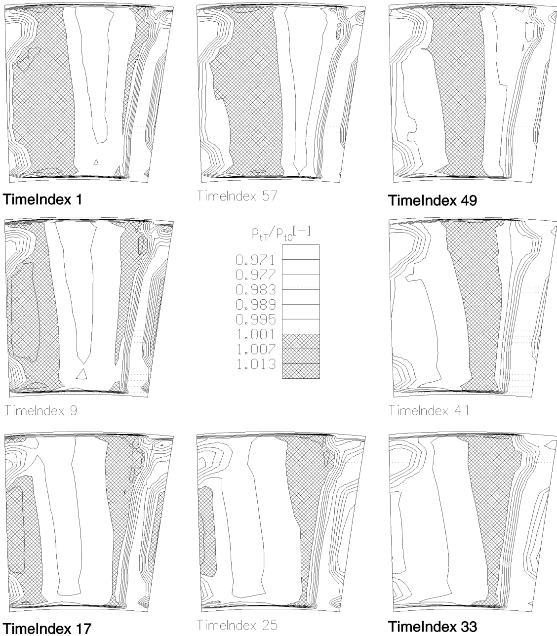
Bild 5.18: Berechnete Verteilung des absoluten Totaldrucks zwischen dem ersten Leitrad und dem Laufrad während einer Schaufelwechselperiode (der dargestellte Bereich entspricht einer Leitradteilung)
