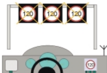
Abb. 7: Ersatz der kollektiven Streckenbeeinflussung durch Mobilfunkterminal als Regelausstattung (SSP Consult Beratende Ingenieure GmbH, Stuttgart, 1999).
