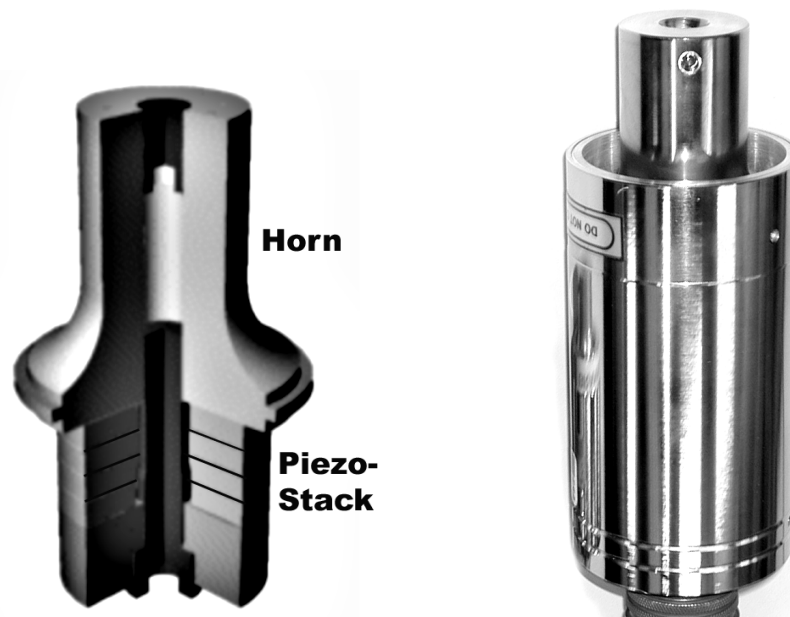
Abb. 15: Prinzipbild (links) und Foto (rechts) eines Ultraschallkonverters
