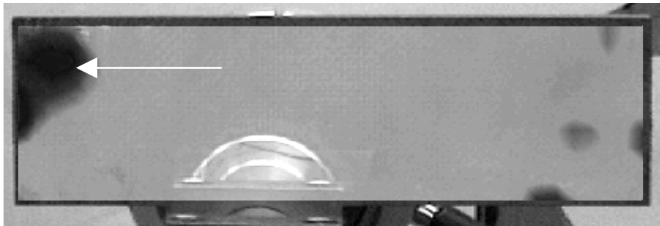
Abb. 68: Delaminierte Mehrschicht C/C-SiC-Keramik, 4. Harmonische (80 kHz)
