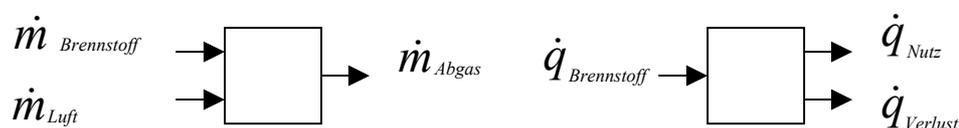
Unter Annahme bestimmter Randbedingungen können die Gleichungen für Massen- und Energiebilanz zu Näherungsgleichungen zusammengefasst werden. Unter den üblichen Betriebsbedingungen von Holzfeuerungen werden mit den nachfolgend erläuterten Näherungsgleichungen gute Übereinstimmungen mit exakt berechneten Werten erzielt, wie am Beispiel von Wirkungsgradbestimmungen von GOOD & NUSSBAUMER (1993) (s. Kap. 9) gezeigt werden konnte.
