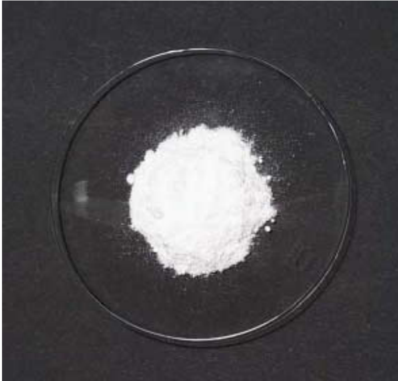
Bild 7.1 DHB Kristallin, durch Extraktion mit Ethylacetat aus Fermentationsmedium aufgereinigt
