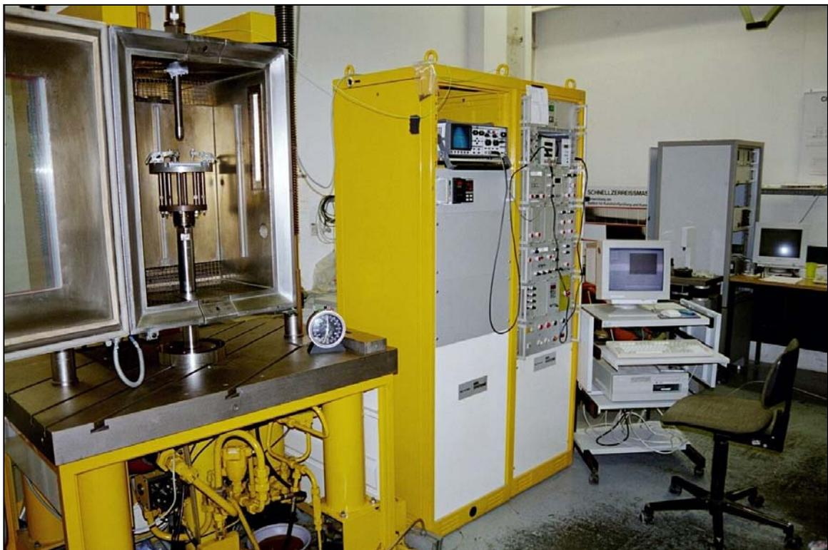
Abbildung 19: TMC-Messaufbau montiert auf hydraulischer Universalprüfmaschine HUS
