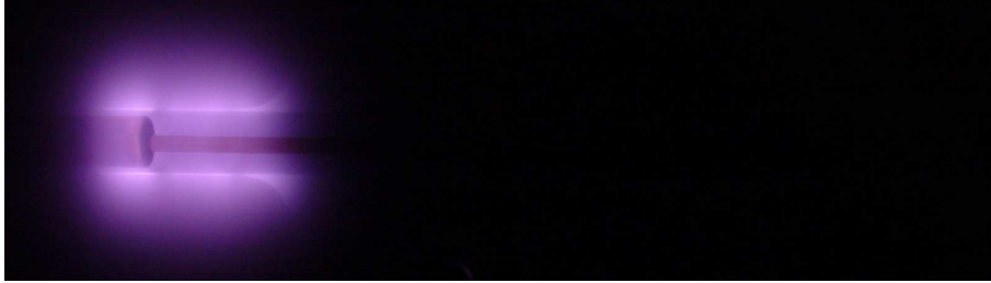
Abbildung 2.2: Einseitige Einspeisung einer geringen Mikrowellenleistung in eine Duo-Plasmaline ( H_2 , 30Pa, 200W), die sich über das gesamte Bild erstreckt.
