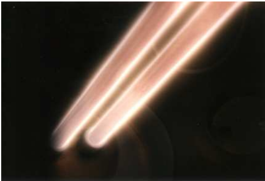
Abbildung 2.19: Doppelte Anordnung der Duo-Plasmaline mit einem Sauerstoffplasma bei 100Pa.
