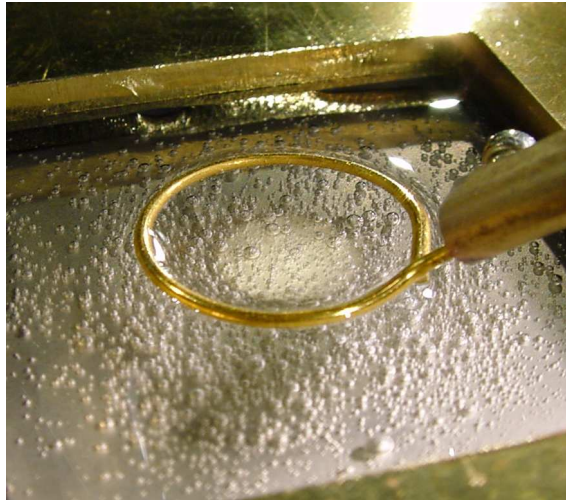
Abbildung 3.7: Elektrolyse an einem nicht beschichteten Substrat mit einer Ringelektrode.
