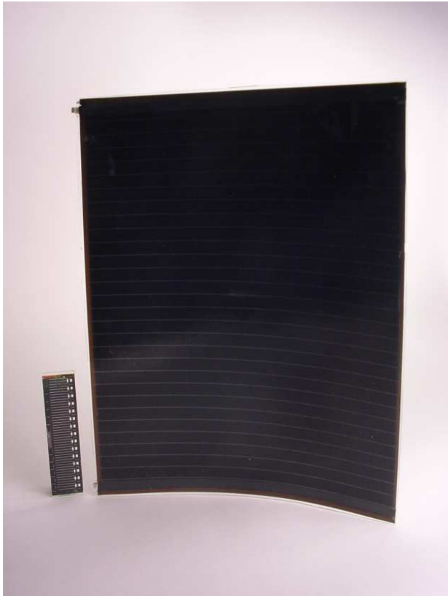
Abbildung 4.35: Vergleich eines der ersten Testsubstrate aus Glas zur Zellwirkungsgradbestimmung mit einem flexiblen Solarmodul der Größe 20 \times 30\text{cm}^2 auf Titanfolie. Eine 4\mu\text{m} dicke plasma-polymerisierte \text{SiO}_x -Schicht dient als Diffusions- und Isolationsbarriere und ermöglicht den seriellen Dünnschichtaufbau der CIGS-Solarzellen.
