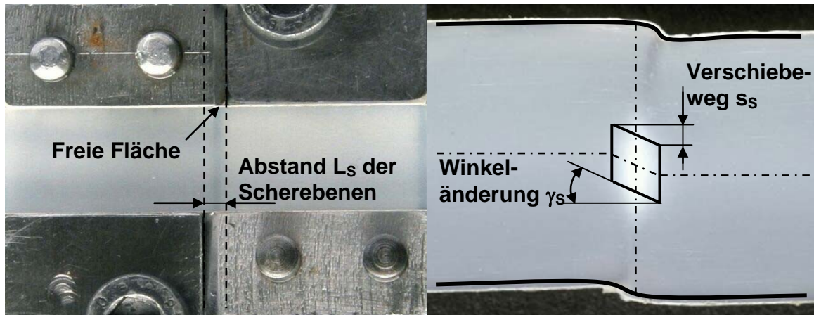
Abbildung 3.10: Verformung der Probe durch Verschiebung der Scherebenen
