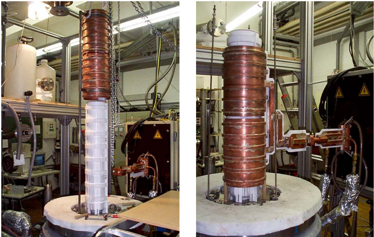
Abbildung 3-3: Induktive Beheizung der Kugelschüttung (PTFE-Behälter)
