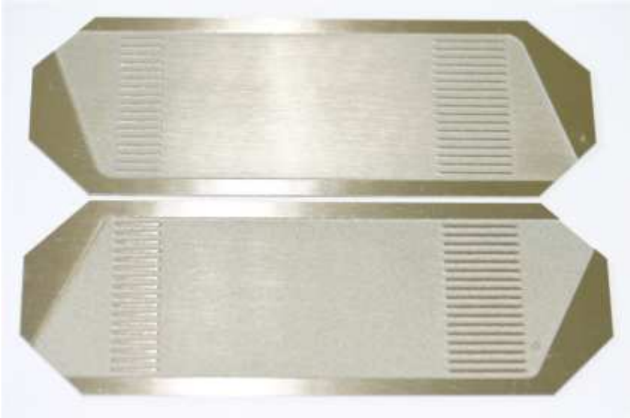
Abbildung 8.5: R INT-1: Geätzte Kanalstrukturbleche vor katalytischer Beschichtung. Abb. 7.13 wird für die jeweilige Katalysatoraufbringung zugrunde gelegt. Oberes Blech: Durchführung der Oxidation. Unteres Blech: Durchführung der Reformierung. Werkstoff der Bleche: 2.4816.
