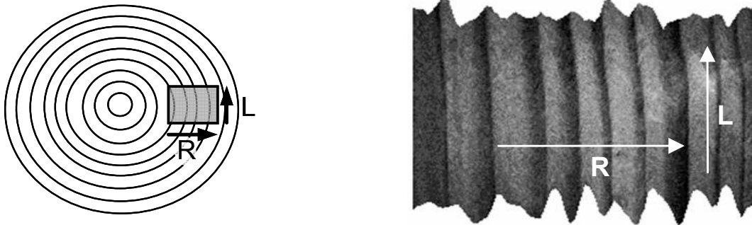
Abbildung 6.8: Scanfeldposition auf dem Fichtenstammquerschnitt (links) und dreidimensionale Darstellung der dritten Harmonischen in der LR-Ebene (rechts) [83].
