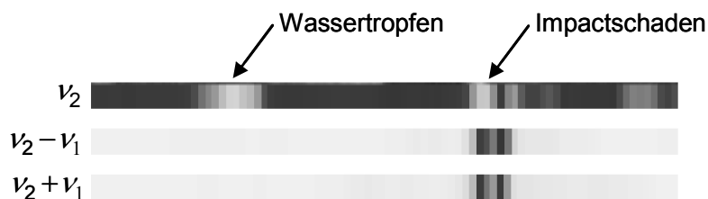
Abbildung 6.23: Farbkodierte Linienscans über eine PS-Probe. Abbildung mit Amplitude der Prüffrequenz ( \nu_2 ) und ersten Mischfrequenzen. Unterscheidung von Defekttypen: Linearer Defekt Wassertropfen (links) im Vergleich zu einem Bruchschaden (rechts) auf der Oberfläche.
