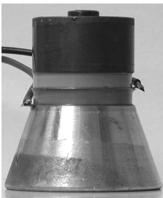
Abbildung 4.4: Wandler-System Piezostack mit Eigenfrequenzspektrum.
