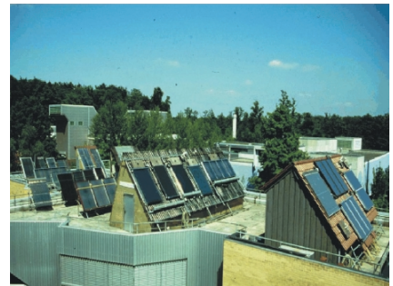
Abb. 25: Außenprüfstände für Kollektoren und Solaranlagen am Forschungs- und Testzentrum für Solaranlagen, Stuttgart.
