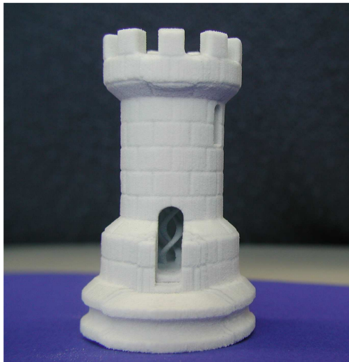
Abb.2.24: Gefinischtes Bauteile mit komplexen Innenstrukturen (Gesamthöhe 50 mm)
