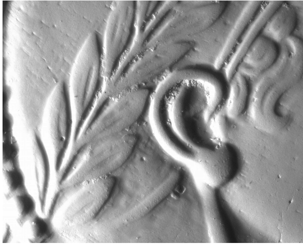
Abb.3.27: Oberfläche einer gesinterten \text{Al}_2\text{O}_3 -Keramikmedaille aus Gelatineschlicker
