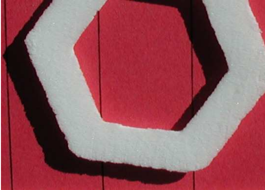
Abb.2.18: Unscharfe Bauteilränder beim Drucken mit reinem Isopropanol
