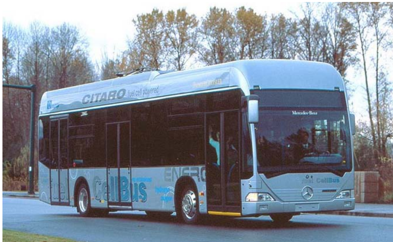
Abbildung A.1: Brennstoffzellenbus (BZ-Citaro) der Firma EvoBus
