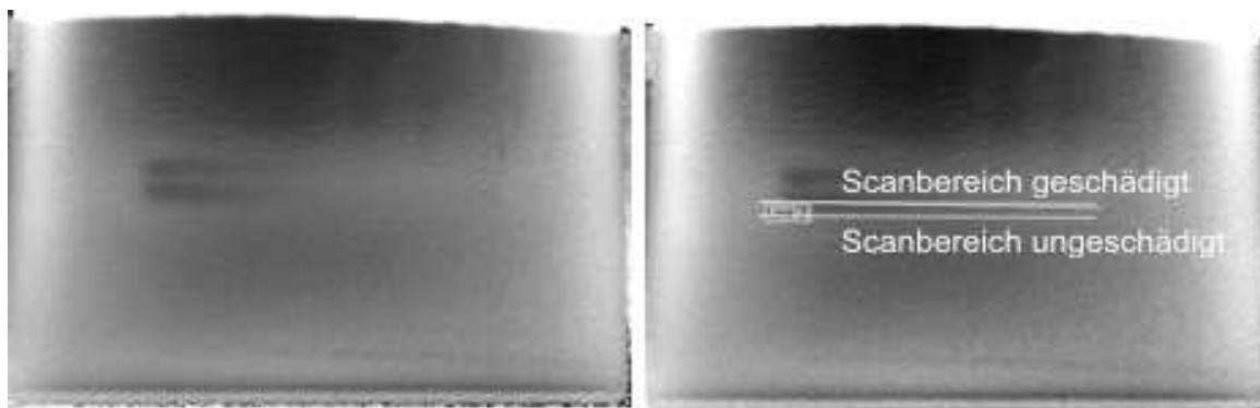
Abbildung 4.13: Stahlprobe mit Einfräsungen auf der Rückseite. Links: ILT Phasenbild bei 0,5 Hz. Rechts: Messprofil für Diagramm.
