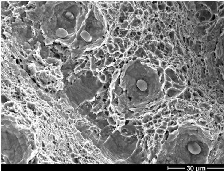
Bild 2.8: Wabenbruchfläche, Werkstoff 22NiMoCr3-7, REM
