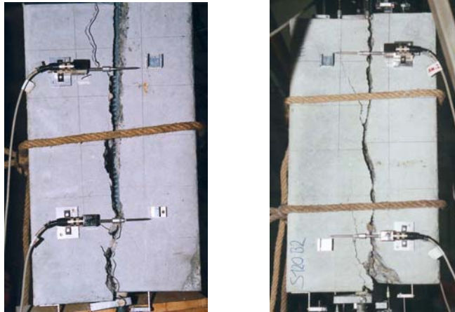
Bild 3.74 Typische Bruchbilder der Versuchskörper ohne Querbewehrung
