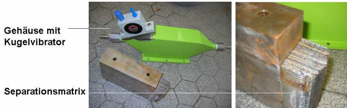
Abbildung 3-2: Separationskassette der HGMF Anlage. Die Abbildung zeigt sowohl das Gehäuse der Separationskassette mit aufgesetztem Kugelvibrator, als auch die Separationsmatrix bestehend aus einer Folge von magnetischen und nicht magnetischen Stahlnetzen.
