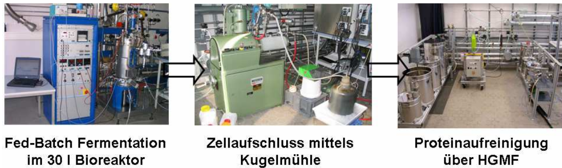
Abbildung 5-2: Schematische Darstellung des sequentiell ablaufenden Produktions- und Aufreinigungsprozesses der Haloalkan Dehalogenase DhaA CYYF . Im Anschluss an die Produktion des rekombinanten Enzyms innerhalb eines Bioreaktors, findet der Zellaufschluss mittels einer kontinuierlichen Kugelmühle statt. Anschließend erfolgt die Aufreinigung des Biokatalysators mittels der Magnettrenntechnik aus dem Zellrohextrakt, wobei eine Ultrafiltration zur Konditionierung des Endprodukts in die Anlage integriert wird.
