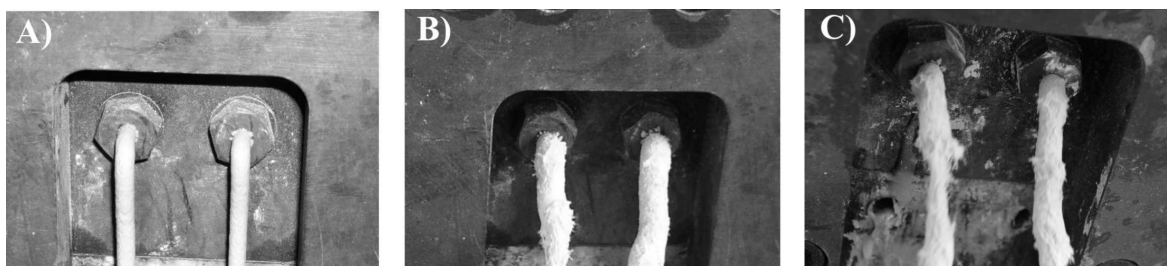
Bild 4.16: Strangextrusion mit optimierter Duroplastdüse: A) keine sichtbaren Vernetzungserscheinungen, B) leichtes Aufschäumen und Aufreißen der Strangoberflächen, C) starkes Aufreißen der Strangoberflächen sowie unregelmäßiger Materialausstoß
